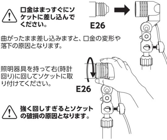
ホルダー固定用ボルトをゆるめ角度調整できます。
