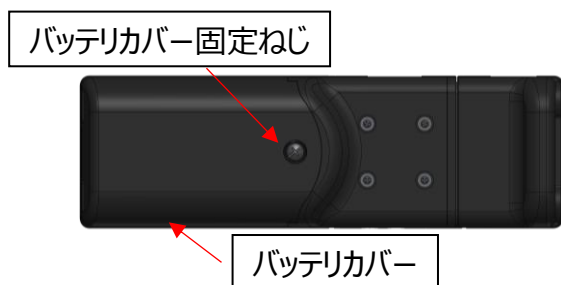
光ファイバホットストリップ S251A 本体底面 (バッテリーカバーあり)
