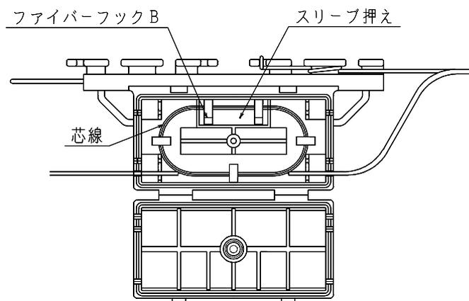
4. 蓋を閉めて蓋爪が蓋爪孔に入りパチッというまで閉め、蓋ねじを蓋ねじ孔に入れて締め付け、芯線収納体と蓋体の接触面に隙間のないようにします。
