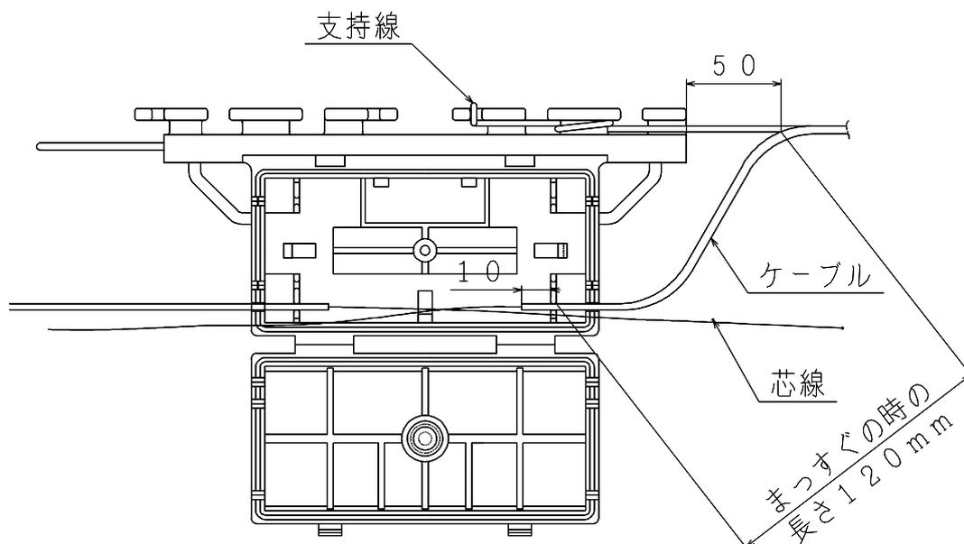
2. ケーブルをケーブル把持片に装着します。図の向きに奥まで差し込みます。
