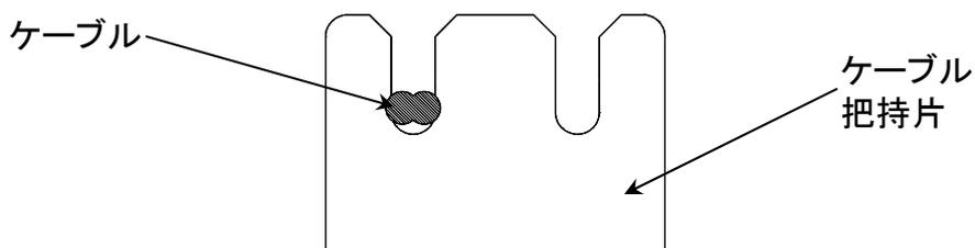
3. ケーブル導入孔に合わないケーブルをご使用の場合は、コーキングなどの止水処理を施してください。他のケーブル導入孔を使う場合は、止水片をニッパーなどで切り取ってお使い下さい。
