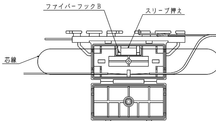
3. 芯線をターンさせながら芯線収納体のファイバーフックAと、ファイバーフックBの上段に収めます。
