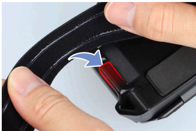
③電池ボックス部の両スリットへ通す
