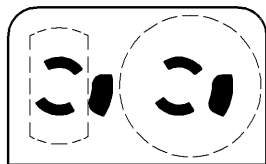
φ39までの接地2P丸形プラグ1個と2P平形プラグ1個
