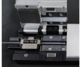
**2**:ヒーターランプが点灯していることを確認し、ホルダ台をスライドします。
