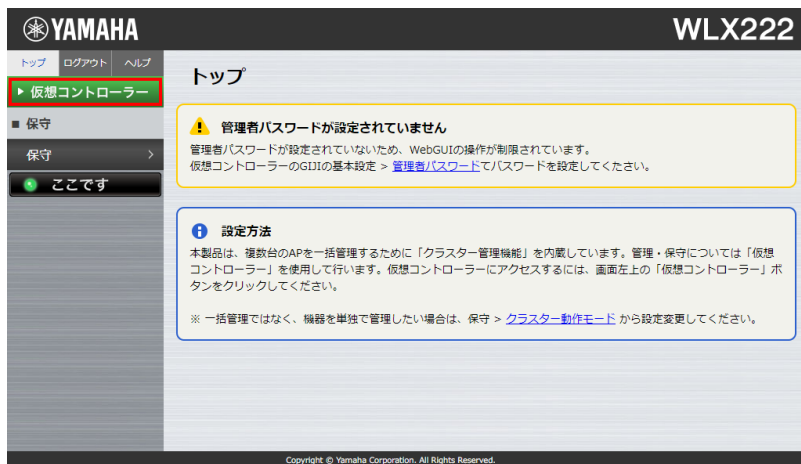
APのWeb GUI [トップ] (管理パスワードが未設定の注意表示)
