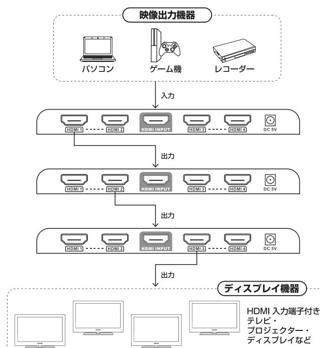
3段階カスケード接続例。最大 16 台（5段階）の HDMI 機器に同時分配可能。
