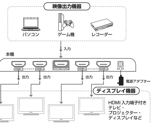
1. 本体のHDMI入力ポートに映像出力機器を接続します。
