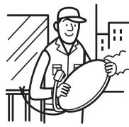
作業中、アンテナや取付金具、工具を落下させたりしないよう、ヒモを取付けると安全です。
