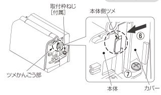
(8) 化粧カバーを取り付ける 化粧力バー下端を目印線に合わせ、押し下げてください。
