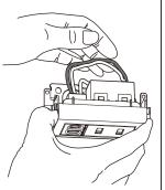
適正締付けトルク 0.2 N·m~0.4 N·m
