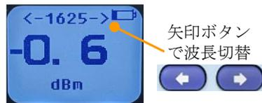
【Shift → Zero】この手順でキーを押すと自動的にゼロ設定が行われます。自動ゼロ設定を行う時はコネクタキャップをしっかりと取り付けてください。
