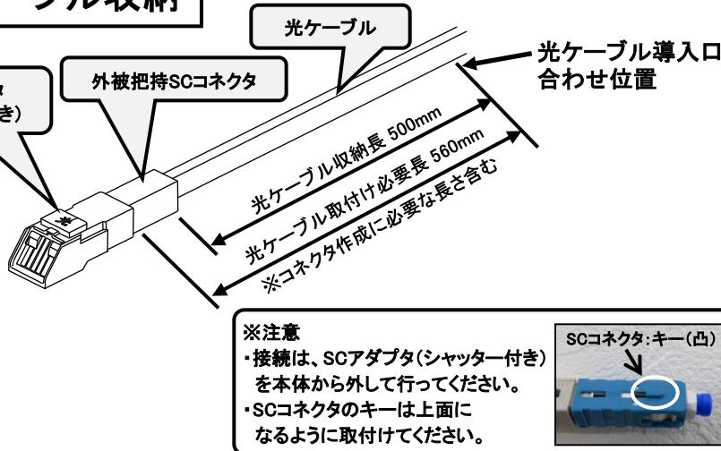
SCアダプタ(シャッター付き)に外被把持SCコネクタを接続後、光ケーブルを本体に収納します。
