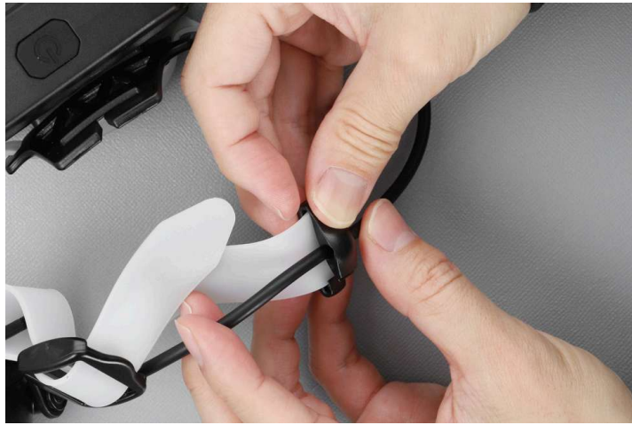
⑨最後にケーブルホルダーにケーブルを挟む（2個）
