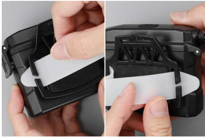
②電池ボックスの両側のスリットにシリコンバンドを端から通す
