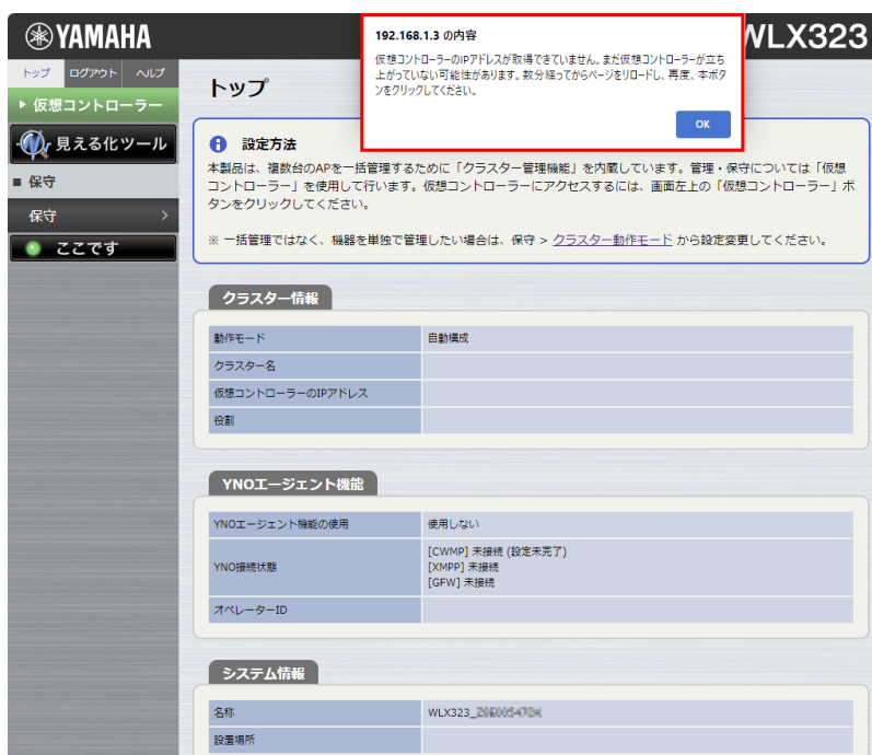
無線APのWeb GUI [トップ] (仮想コントローラーが起動中の場合の注意表示)
