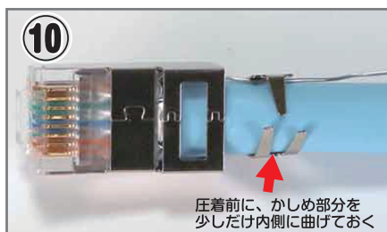
⑩ プラグの接触部圧着とプラグ先端のケーブルのカットが完了されたら、かしめ部分を少しだけ内側に曲げておきます。
