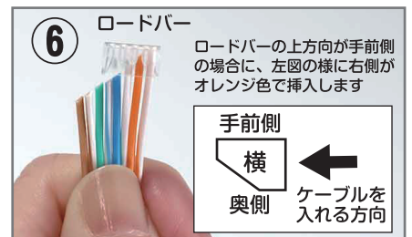
⑥ ロードバー ロードバーの上方向が手前側の場合に、左図の様に右側がオレンジ色で挿入します 手前側 横 奥側 ケーブルを入れる方向
