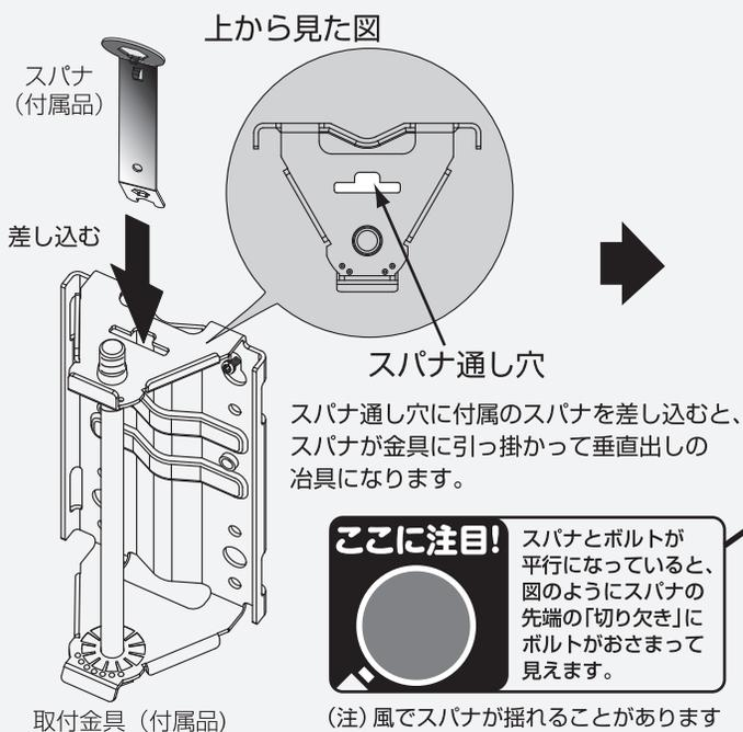
**ここに注目!** スパナとボルトが平行になっていると、図のようにスパナの先端の「切り欠き」にボルトがおさまって見えます。
