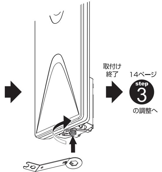
アンテナの方向調整を行なうため、アンテナ本体を手で動かせる程度に六角ボルトを軽く締めてください
