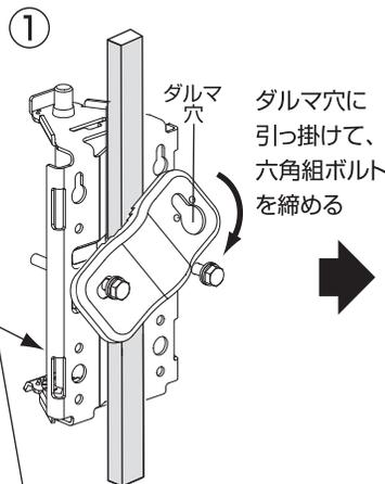
矢印の刻印が、必ず上向きになるように取付金具を設置してください。
