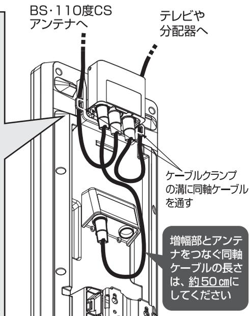
ケーブルクランプの溝に同軸ケーブルを通す
