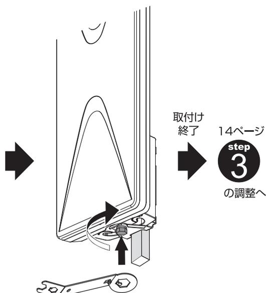
アンテナの方向調整を行なうため、アンテナ本体を手で動かせる程度に六角ボルトを軽く締めてください
