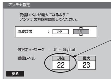
できる限り大きくするようにアンテナの向きを調整してください。
