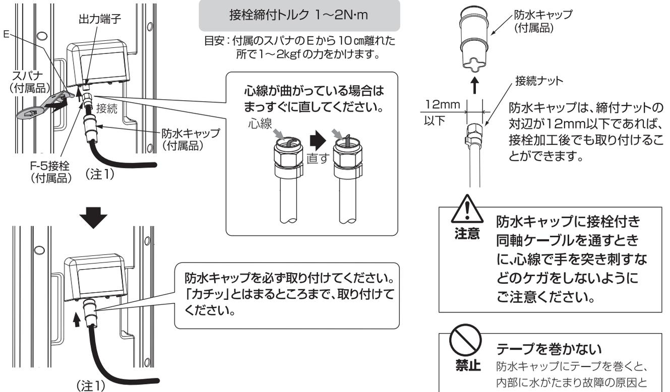
(注1) 5C相当同軸ケーブルの曲げ半径は、半径30mm以上にしてください。
