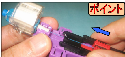
挿入ガイドの上を滑らせながらファイバ挿入
