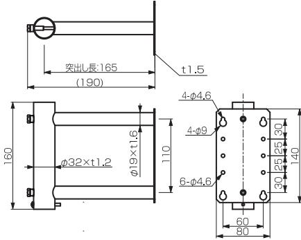
〈MW20S〉 ●適合マスト径: φ22~32mm ●重量: 0.6kg
