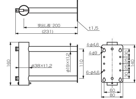
〈MW20Z〉 ●適合マスト径: φ22~32mm ●重量: 1.0kg
