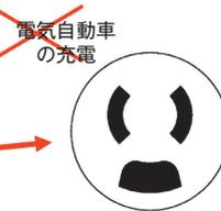
抜止コンセントの極配置 (JIS C 8303 付図A-17)
