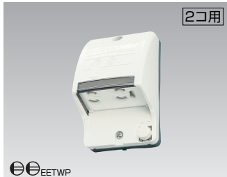
2コ用 アース付・アースターミナル付防水コンセント(2コ用) DC1092N(W) ￥1,520 ●2コ用 ●15A-125V AC ●防雨形(IPX3) ●φ50(5) ●JIS規格1コ用露出ボックス対応 ●ホワイト色
