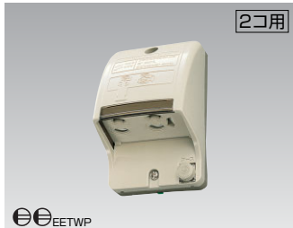
2コ用 アース付・アースターミナル付防水コンセント(2コ用) DC1092N(C) ￥1,520 ●2コ用 ●15A-125V AC ●防雨形(IPX3) ●φ50(5) ●JIS規格1コ用露出ボックス対応 ●ベージュ色
