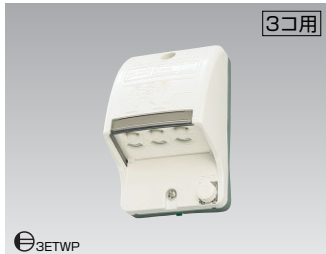
3コ用 アースターミナル付防水コンセント(3コ用) DC1093N(W) ￥1,520 ●3コ用 ●15A-125V AC ●防雨形(IPX3) ●φ50(5) ●JIS規格1コ用露出ボックス対応 ●ホワイト色
