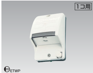
1コ用 アースターミナル付防水コンセント(1コ用) DC1091N(W) ￥1,500 ●1コ用 ●15A-125V AC ●防雨形(IPX3) ●φ50(5) ●JIS規格1コ用露出ボックス対応 ●ホワイト色
