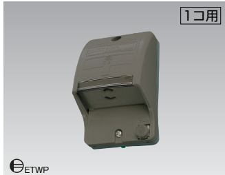
1コ用 アースターミナル付防水コンセント(1コ用) DC1091N(T) ￥1,500 ●1コ用 ●15A-125V AC ●防雨形(IPX3) ●φ50(5) ●JIS規格1コ用露出ボックス対応 ●ブラウン色
