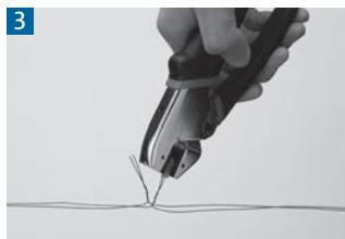
専用圧着工具の圧着工具E-9Jの圧着面全体で正しくはさんでストッパーが作動する点まで十分に圧着する。確実に接続できているかをもう一度コネクタ裏面より確認する。
