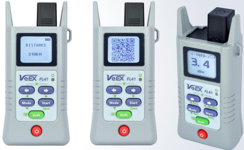
FL41は、最大20kmのファイバースパンを測定するための手のひらサイズの低価格な光ケーブルの故障診断ツールです。FL41fは、サービス中の故障箇所を特定するためのフィルターを内蔵しています。FL41は、光パワーメータ機能を実装しており、PON、5G、FTTx、LAN/WAN、CATVアプリケーションでのファイバーリンクやドロップファイバーを保守する技術者に最適なツールです。
