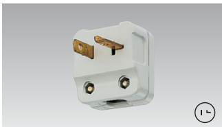
20A 125V横出しキャップ DH1202 ¥410 ○ ●20A-125V AC ●●100(10) 適合コード：ビニルキャブタイヤ丸形コード3心 VCTF 0.75mm 2 /1.25mm 2 /2mm 2 ゴム絶縁キャブタイヤ丸形コード CTF 0.75mm 2 /1.25mm 2 /2mm 2
