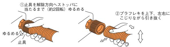
⚠️ 解除後、必ず止具を接続方向に締め戻してください。
