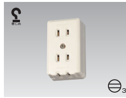
L形トリプルコンセント DC1143(W) ¥540〇 ●15A-125V AC ●●100(10) (送りなし)
