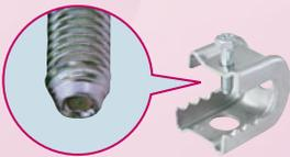
ねじの先端部をくぼませて、造管材に広く大きく、食い込むようにしてあります。引っ張り荷重に対して先端がすべりにくい特性があります。
