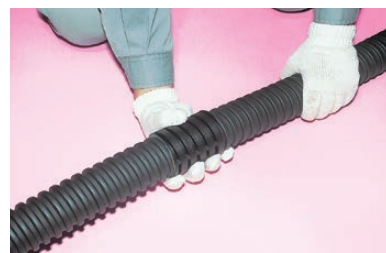
③エフレックスの突き合わせが中央に来るようにアクアフィットを逆方向にねじ戻して接続施工完了です。
