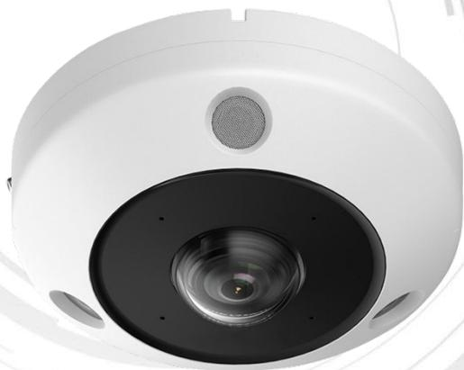
6MPの高解像度を備えたAI搭載のフィッシュアイネットワークカメラです。広角1.16mmレンズにより水平・垂直ともに180°の視野を確保し、映像を通常の画面やパノラマなど、用途に応じた表示方法に切り替え映像表示が可能です。内蔵マイクとスピーカーによる双方向音声通信、最大15mの赤外線照射で暗所でも鮮明な映像を提供します。さらにIP67防水防塵、IK10耐衝撃性能を備え、屋外環境でも安心して使用可能です。ディープラーニングアルゴリズムによる人数カウント、ヒートマップ、キー管理など高度な解析機能を搭載し、セキュリティだけでなく店舗や施設の運営効率化にも貢献します。多彩な表示モードや強力なイベント検知機能を備え、監視用途からビジネス分析まで幅広く活用できる高性能モデルです。
