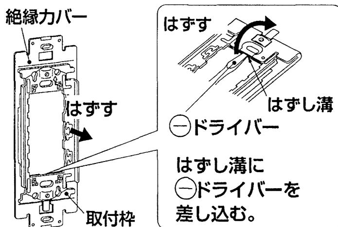
(2) 絶縁カバーに取付枠付器具を取り付ける。
