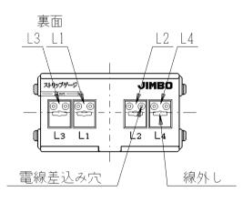
■適用電線 : Ø 0.4~ Ø 0.65銅単線専用
