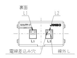
■接触ピンの接続図(正面図)
