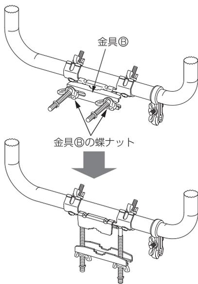
**5** マスト固定金具(金具⑧)の蝶ナット(2個)を指定のトルクで均等にしっかりと締付けます。
