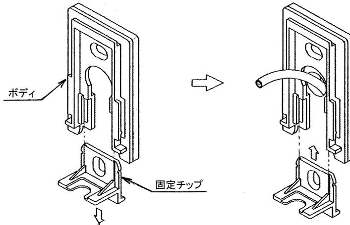
(注記1) 10を超える電線を入線する場合は、固定チップのノックアウト部(斜線部)をニッパ等で切り取ってください。
