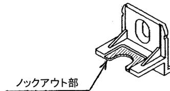
(3)壁の穴がボディの中心にくる様に▼マークで位置合せをして、ボディを木ねじで固定してください。
